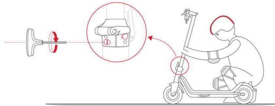
Tarkista, ovatko pystyputken ruuvit löysällä. Jos näin on, kiinnitä ensin kannatinputken ruuvit ja kiinnitä sitten taittomekanismin kaksi ruuvia 6 mm:n kuusikokoloavaimella.
