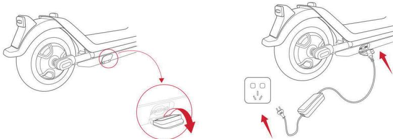
Avaa ensin latausliitin, liitä sitten latauspistoke rungon latausliittimeen ja kytke sitten virtalähde pistorasiaan. Kun lataus on valmis, sulje latausliittimen tulppa, jotta vesi ei pääse sisään.
